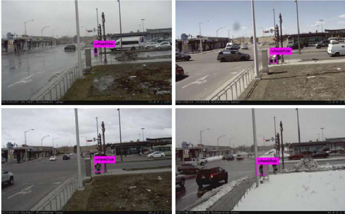
Détection des piétons à mobilité réduite (intelligence artificielle / apprentissage profond **YOLOV3**)
