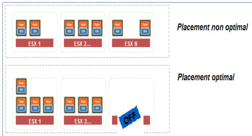
FIGURE 3 – Exemple de placement de VMs : impacts sur le Capex
